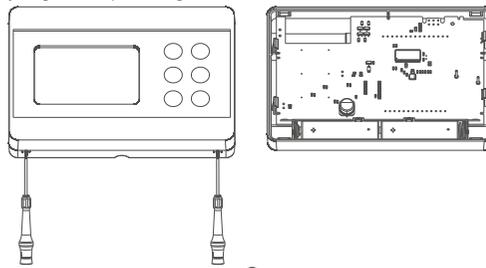
Como se muestra en la imagen anterior, presione el destornillador hacia adelante desde el espacio que se muestra, doble las lengüetas y separe la cubierta frontal. Introduzca 2 pilas alcalinas AAA nuevas en la caja de las pilas con la dirección correcta. Sustituya las dos pilas al mismo tiempo. A continuación, alinee la parte delantera de su termostato ambiente con la parte trasera y apriétela hacia la parte posterior.
